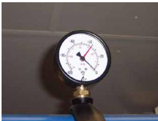
*Vakuummeter mit aktueller (schwarz) und angestrebter (rot) Vakuumhöhe*
